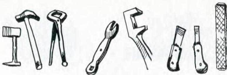
Ковочный инструмент: обсечка; ковочный молоток; ковочные клещи; шиповый ключ; лапа; копытный рашпиль; копытный нож; секач
