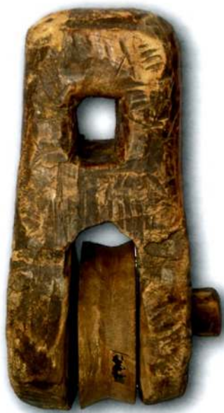
Рис. 61. Деревянный блок для подымания ульев. К а й л и н о - к а р ш и н ц ы
