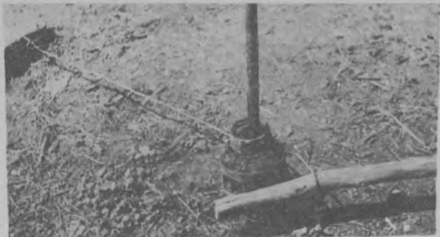
Приспособление, облегчающее гнутье древесины. Фото автора (д. Аралбаево Зилаирского р-на БАССР; 1974 г.).
