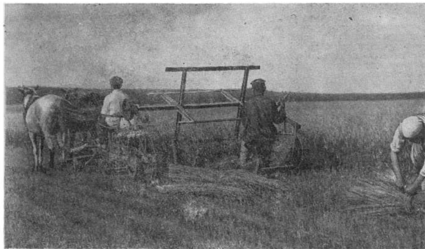
Р и с. 16. Уборка ржи жнейкой-лобогрейкой. Дер. Қандры, Белебейский кантон БАССР, 1930 г., татары.
